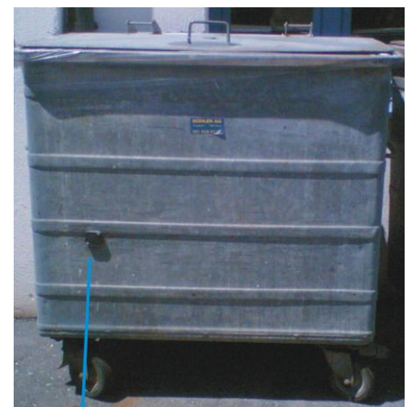
Container-Identifikation Das Netto-Leerungsgewicht wird mit der geeichten Waage ermittelt und zusammen mit der Chip-Identifikationsnummer in den LKW-Bordcomputer geschrieben.
